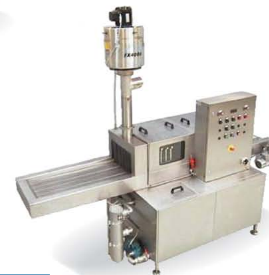
Automatyczna, przelotowa myjnia natryskowa 2-strefowa do mycia małych detali, Widoczny układ kondensacji pary wodnej (jako opcja)
