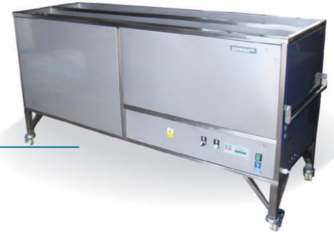
Myjnia ultradźwiękowa przystosowana do mycia verticali oraz żaluzji. Urządzenie posiada dwie komory: mycia ultradźwiękowego oraz płukania wzbogaconego o system napowietrzania kąpieli.
