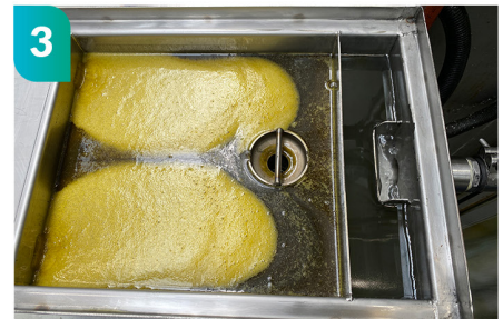
3 Proces odolejania koalescencyjnego, który zachodzi bezpośrednio w odolejaczu QS polegający na separacji oleju
