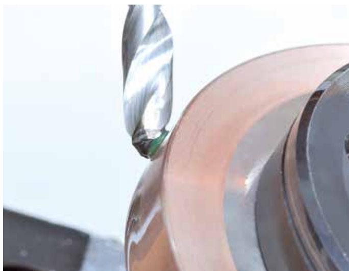
/// OBRÓBKA ELEKTROEROZYJNA LINII ŚRUBOWEJ wiertła spiralnego PCD
