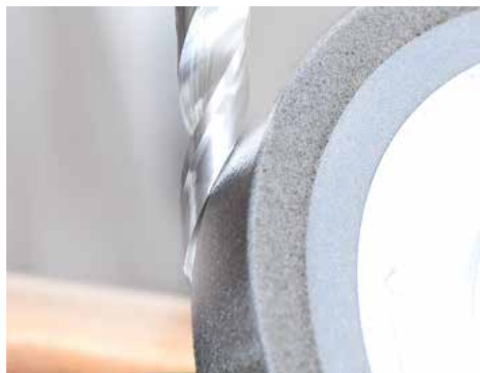
/// SZLIFOWANIE LINII SPIRALNEJ wiertła spiralnego PCD
