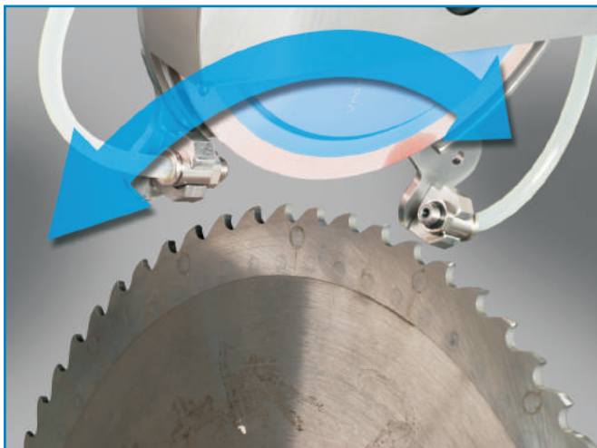
Obrót głowicy szlifującej w procesie automatycznego fazowania
