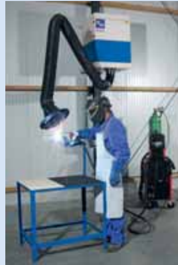
Przykład zastosowania: CAREMASTER do montażu na ścianie z dodatkową nasadką na ssawce odciągowej.
