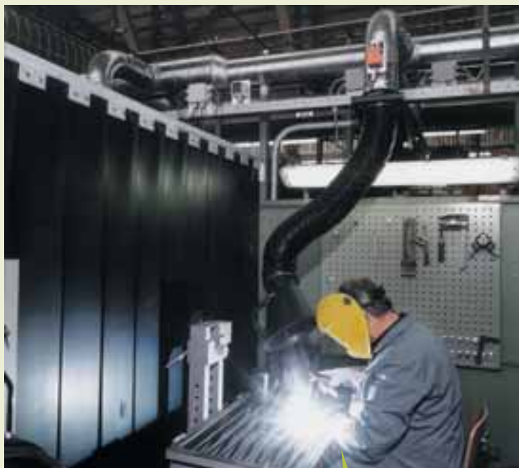
Przykład zastosowania: ramię teleskopowe w kabine spawalniczej
