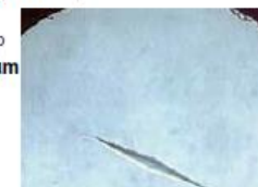
Mikrografia stopionego, kuliastego węgla wolframu, 160 µm ze skalą twardości metodą Knoop pod obciążeniem 1 kg (2,2 funta)
