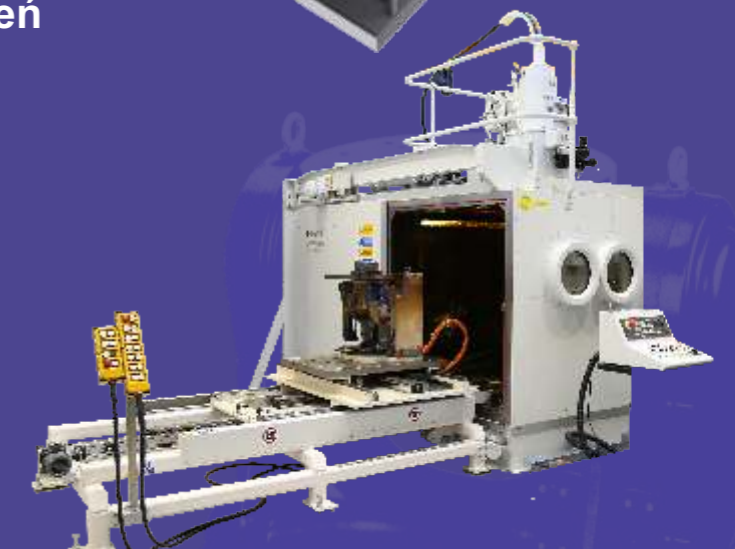
Urządzenie do spawania elektronowego zainstalowane w IS Gliwice
