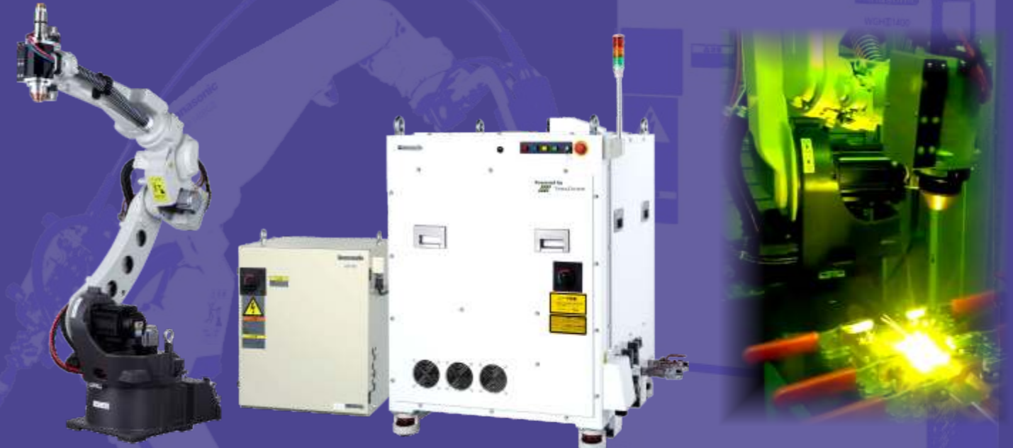
Zrobotyzowane stanowisko do spawania laserowego LAPRISS (laser trzeciej generacji, DDL - Direct Diode Laser)
