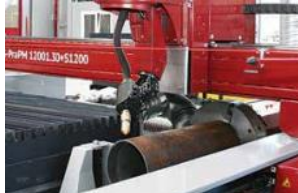
Cięcie rur i profili w 3D do \varnothing 1000 mm
