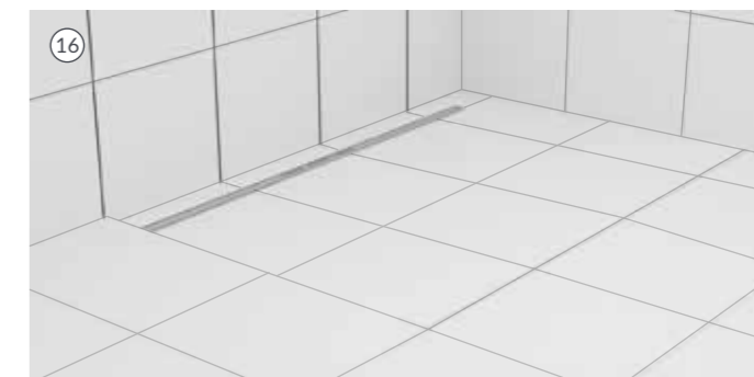
16. Po odczekaniu minimalnego czasu zalecanego przez producenta (Wiper Tanking Kit - to tylko 1,5 godziny) można przystąpić do klejenia płytek.
