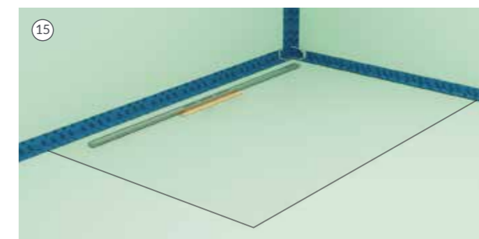
15. Wykonać pełną izolację kabiny prysznicowej zgodnie z wybraną technologią, np. używając zalecanego systemu WIPER Tanking Kit. Bezpośrednio po posmarowaniu folię w płynie powierzchni wokół bazy należy osadzić na niej rynnę w położeniu docelowym.
