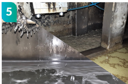
5 P porównanie kąpieli przed i po zastosowaniu odolejacza
