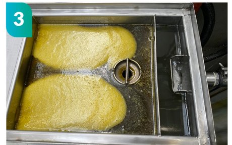
3 P proces odolejania koalescencyjnego, który zachodzi bezpośrednio w odolejaczu QS polegający na separacji oleju
