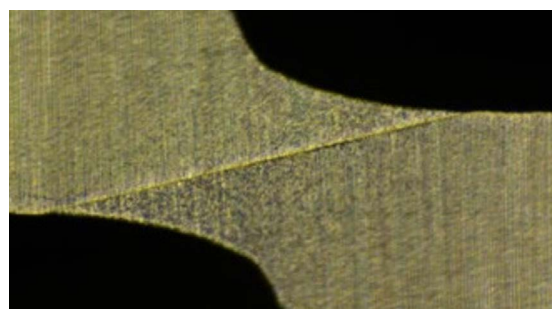
Obszar ścinu przy 446-krotnym powiększeniu na MX7 ULTRA
