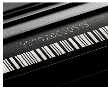
Kontrastowe oznaczenie na tworzywie sztucznym
