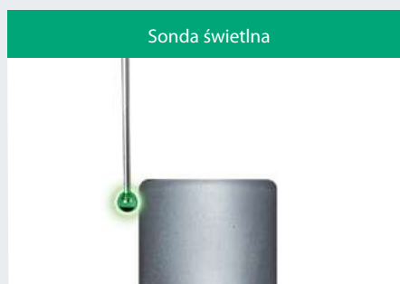
Ponieważ siła nacisku jest wyjątkowo niska, możliwa jest detekcja bez poruszania części.
