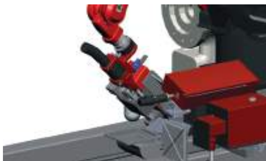
TEES - System wymiany elektrody wolframowej
