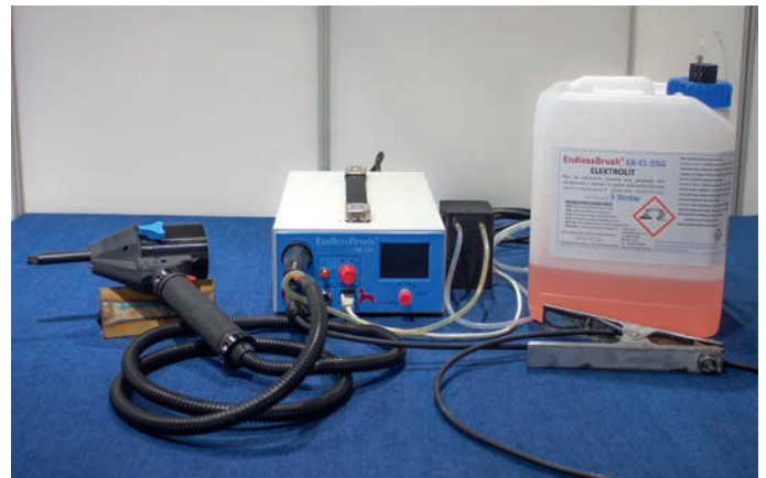
Rys. 2. Urządzenie do elektrolitycznego czyszczenia i pasywacji stali nierdzewnej
