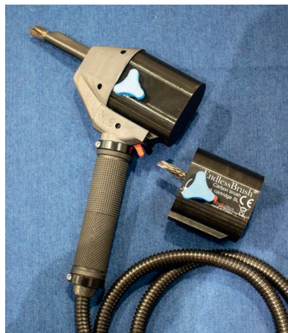
Rys. 3. „Bezkońcowy” pędzel węglowy wyposażony w końcówkę podającą automatycznie elektrolit oraz zasobnik z włosiem węglowym, wynalazek autora, zgłoszony do Urzędu Patentowego RP
