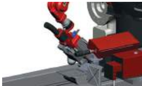
TEES - System wymiany elektrody wolframowej
