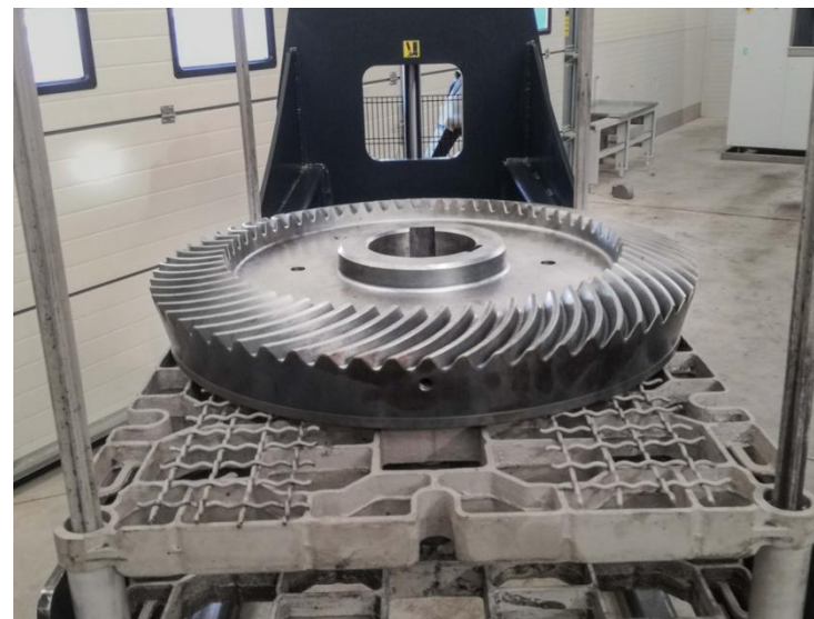
Talerzowe koło zębate o średnicy 600mm przygotowane do hartowania izotermicznego w piecu próżniowym z chłodzeniem gazem obojętnym
