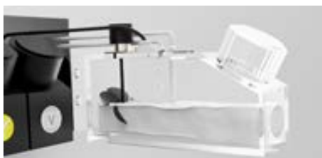
system mieszania białego atramentu
