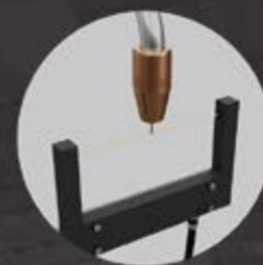
Laserowy pomiar punktu TCP
